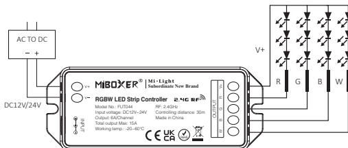
FUT044 Kontroler podłącza się do schematu taśmy LED RGBW
